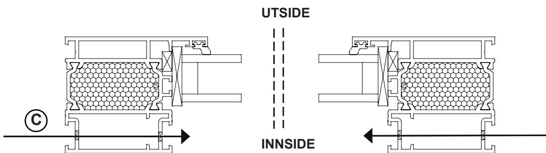
5. Bor først et gjennomgående hull (C) med et 5 mm bor på innsiden av profilen.
