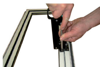
Kiinnitä kahva tämän jälkeen tuuletusikkunaan loppuilla ruuveilla.
