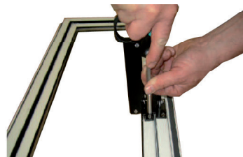
Fäst sedan handtaget i luckan med de resterande skruvarna.
